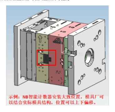
EMITTIMS模具智能计数器是广东新睿仕德智能系统有限公司开发的模具智能化数据采集器,属于无源设备互联智能化数据采集器。产品自带无线定位模块、计数模块和数据传输模块。主要功能是自动为模具提供位置信息、数量信息和成型周期等信息,利用以上信息通过软件系统大量逻辑运算为模具全流程监控和运营提供智能化管理。运营管理平台主要解决大量模具在注塑和冲压生产过程中运营管理难的痛点问题,应用场景:主机企业(美的、华为等)有大量模具外发多家供应商生产[MITT模具生产运营智能管理系统化解决方案,通过模具智能RFID数据采集器[4G]5G智能采集器配合智能化管理系统对模具进行全生命周期管理,解决企业大量模具外协供应商生产难以运营管理的痛点问题。计数架构:每套模具安装智能数据采集器一个(内置定位、计数、通讯模块)自动采集数据,系统通过4G[5G通讯基站定位及传输数据,云端服务器数据运算;云端服务器运行智能化管理系统,通过系统完成数据智能化运算,展示在企业PC端、移动端和电子看板;通过模具智能数据采集器实时采集数据,云端计算,通过PC端、移动端和电子看板呈现数据报表、异常实时提醒等智能化管理。102
